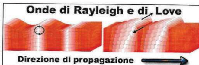
Figura 1: Rappresentazione grafica della propagazione delle onde superficiali di Rayleigh.
