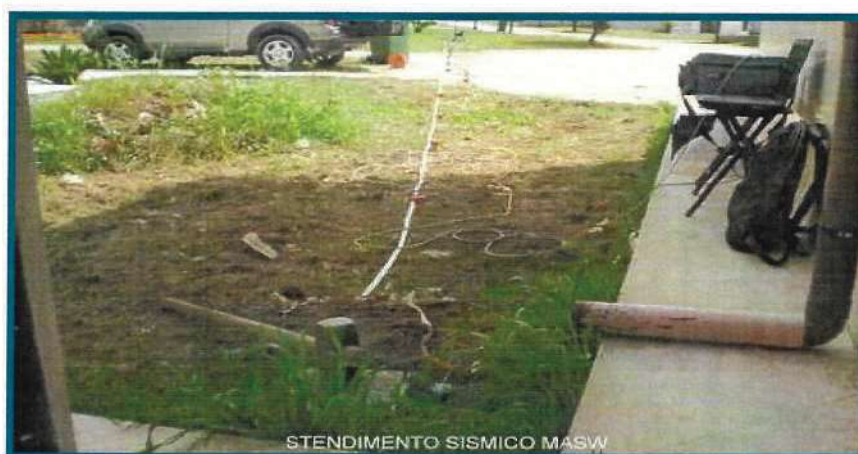
Figura 2: ESEMPIO DI STENDIMENTO SISMICO
